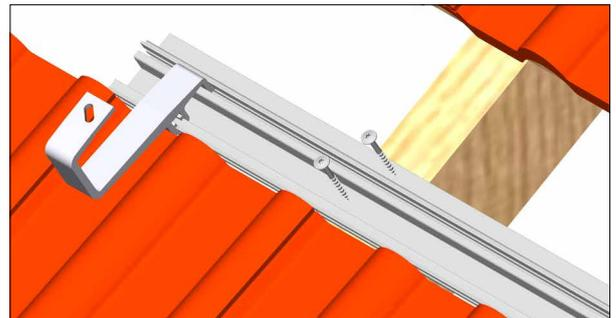
4. Die Platte für die 8.0 mm Tellerkopfschrauben vorbohren.
