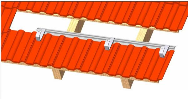
3. Die 1.50 m Platte mit Bügel an die untere Ziegelreihe schieben.
