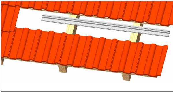
1. Die betreffenden Dachziegel entfernen und die 1.50 m Platte dazwischen auflegen.
