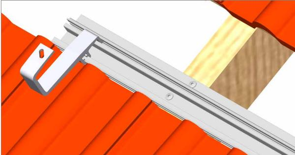
5. Die Platte mit je zwei 8.0 mm Tellerkopfschrauben auf dem Sparren befestigen.
