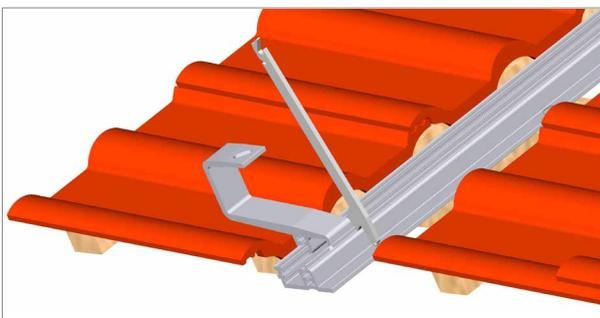
7. Bügel mit Biegewerkzeug horizontal sichern.
