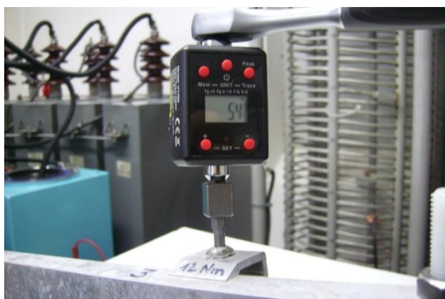
Bild 3.9: Lösedrehmoment (Verbindung 1, Prüfling 3)
